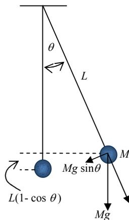
**Gambar 1. 4.** Pendulum, gaya pemulih yang timbul berkaitan dengan pengaruh gravitasi pada massa  $M$ . Dapatkah Anda menyebutkan kondisi apa saja yang berlaku untuk pendulum sederhana seperti di samping?
