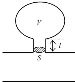
**Gambar 1.7.** Sebuah resonator Helmholtz yang terpasang sebagai percabangan pipa. Bentuk dan volume rongga dapat sangat beragam. Frekuensi ayunan diberikan oleh  $f = (c_0/2\pi) \sqrt{S/Vl}$ , dimana  $c_0$  merupakan kecepatan rambat bunyi di udara.
