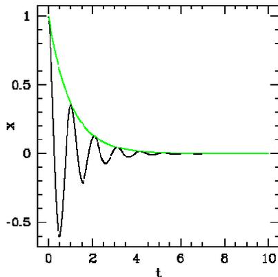
**Gambar 1.9.** Pola penurunan amplitudo dari sebuah fungsi berbentuk  $x(t) = e^{-\alpha t} \cos(2\pi t)$  dengan  $\alpha = 1$ . Pola yang berbeda akan kita peroleh untuk nilai  $\alpha$  yang berbeda. Tampak bahwa ayunan bergerak dengan amplitudo yang terus mengecil menuju nol.
