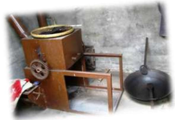
**CARA KERJA:** Tebal hamparan 8 – 10 cm atau 25 – 30 kg kopi HS basah/m<sup>2</sup>. Perpindahan panas dari udara panas ke permukaan biji kopi secara konveksi, diteruskan dari permukaan biji ke dalam biji secara konduksi. Perpindahan masa (air) dari dalam biji kopi ke permukaan biji kopi secara difusi
